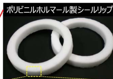
ポリビニルホルマール製シールリング 繊維強化なし (空孔径 & 密度調整のみ)
