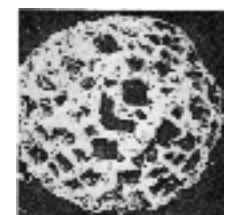
多孔質ガラスビーズの例 (Schott Glaswerke 社) 藤吉宣男: "化学と生物", Vol. 31, No. 1, p.64 (1993)
